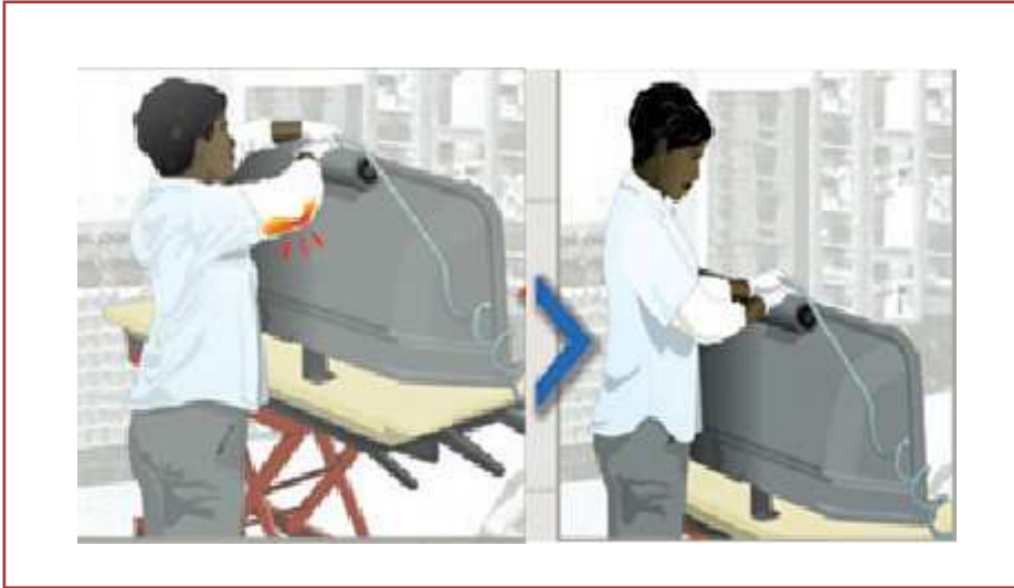
شکل ۵- پوسچر نامناسب آرنج به علت ارتفاع بالای میز کار (تصویر چپ) و عدم تنش متعاقب اصلاح ارتفاع (تصویر راست)
