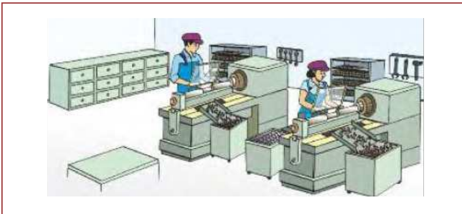
شکل ۱۰- حفظ و نگهداری کارگاه با حذف و خارج کردن کلیه وسایل غیر ضرور و نگهداری ابزارها و وسایل در قفسه
