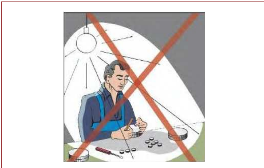
شکل ۱۹- وضعیت نامناسب نور به علت سایه زیاد و ایجاد مزاحمت در انجام کار
