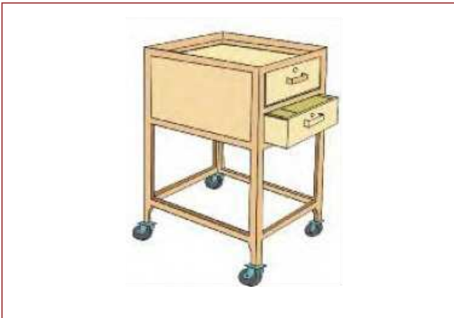
شکل ۳۵- گاری حمل ابزار و تجهیزات به منظور نگهداری و حفاظت وسایل و ابزار و حمل آسان آنها
