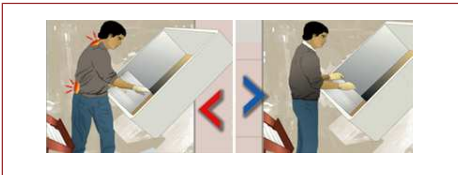
شکل ۴- پوشش نامناسب شانه و کمر به علت قرارگیری نامناسب قفسه (تصویر چپ) و عدم تنش متعاقب اصلاح آن (تصویر راست)
