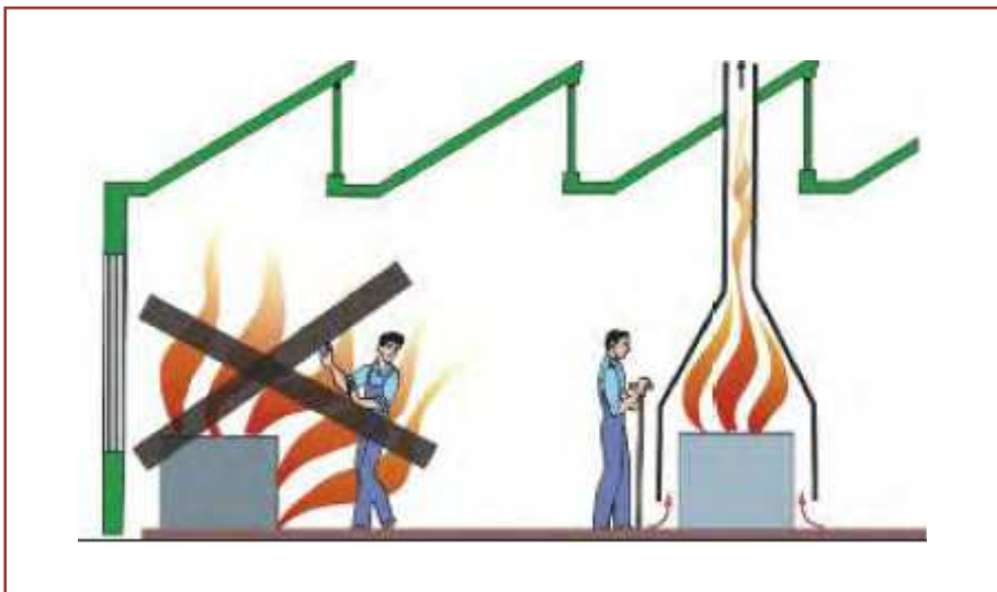
شکل ۵۲- استفاده از تهویه موضعی جهت کنترل گرما و آلودگی محیط کار
